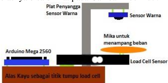
Gambar 2 Perancangan Alat Tampak Samping
