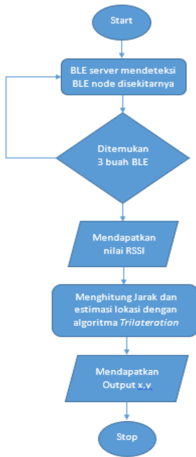
Gambar 3. Flowchart Perancangan Sistem
