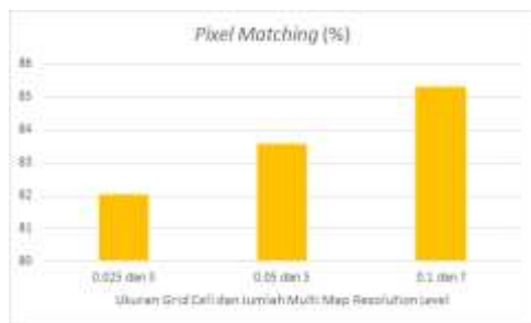
Gambar 19 Histogram Rata – rata Hasil Pixel Matching Pengujian Ukuran Grid Cell dan Jumlah Multi Map Resolution Level
