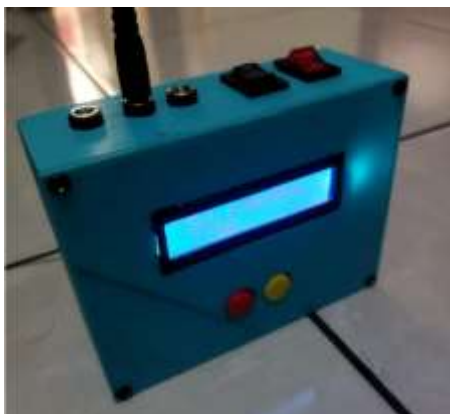
Gambar 8. Penggunaan konektor dan saklar pada rangkaian sistem programmable function generator
