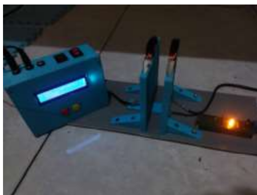
Gambar 11. Rangkaian transmitter WPT yang menggunakan programmable function generator sebagai sumber daya
