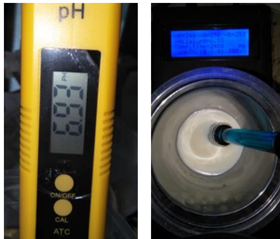
Gambar 9. Pengujian Sensor PH-4502C (kanan) terhadap digital pH meter sebagai acuannya (kiri)
