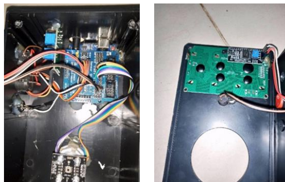
Gambar 7. Implementasi sistem pada saat proses perakitan perangkat keras ( hardware ) yang berupa komponen Arduino UNO dan sensor ( kiri ) dan komponen LCD I2C Display 20 X 4 ( kanan )
