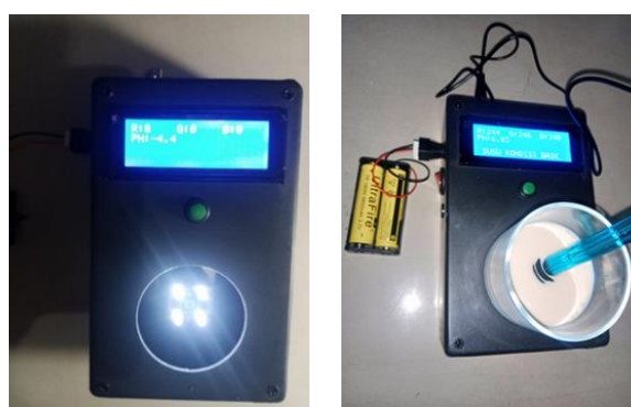
Gambar 8. Implementasi sistem saat proses finishing perangkat keras ( hardware ) yaitu setelah komponen telah selesai dipasang didalam project box ( kiri ) dan proses mengetes ( trial ) untuk alat/perangkat ( kanan )
