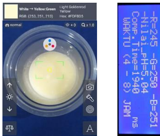
Gambar 10. Pengujian Sensor TCS-3200 (kanan) terhadap aplikasi ColourGrab sebagai acuannya (kiri)
