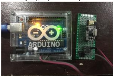
Gambar 12. Implementasi Perangkat Keras Modul Antarmuka dengan Modul Komunikasi NRF24L01
