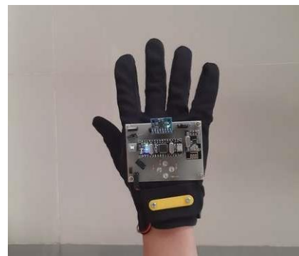
Gambar 8. Implementasi Peletakkan Perangkat Keras Pada Sarung Tangan
