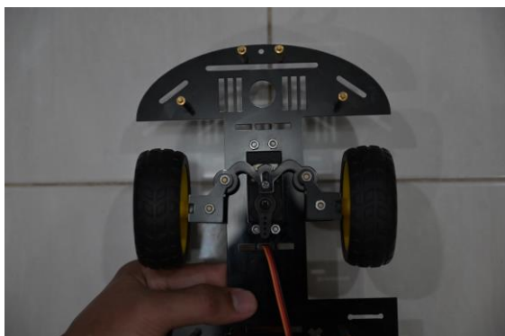
Gambar 9. Implementasi Peletakkan Motor Servo
